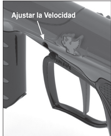
Figura 3: Use una llave Allen de 3/16" para ajustar la velocidad.
